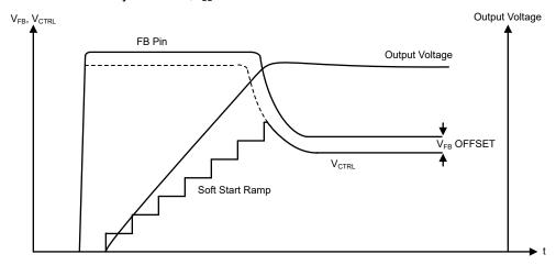
Figure 7-8. Softstart Ramp on Startup
