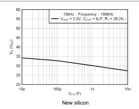
Figure 5-30. TPS73701-Q1 RMS Noise Voltage vs  $C_{\rm FB}$
