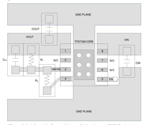
Figure 7-7. Adjustable Output Voltage Option Layout (DRB Package)
