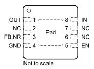
Figure 4-1. DRB Package, 8-Pin VSON (Top View)
