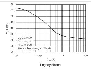
Figure 5-29. TPS73701-Q1 RMS Noise Voltage vs  $\mathrm{C_{FB}}$
