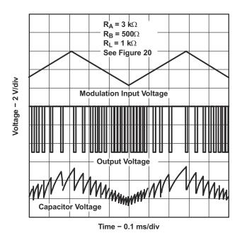
Figure 7-6. Pulse-Position-Modulation Waveforms
