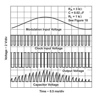
Figure 7-4. Pulse-Width-Modulation Waveforms
