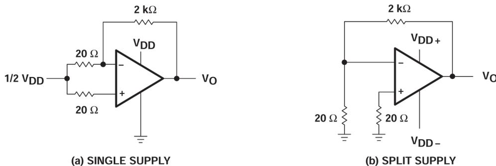
Figure 6-2. Noise-Test Circuit
