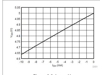
Figure 8-2.  $I_{OH}$  vs  $V_{OH}$
