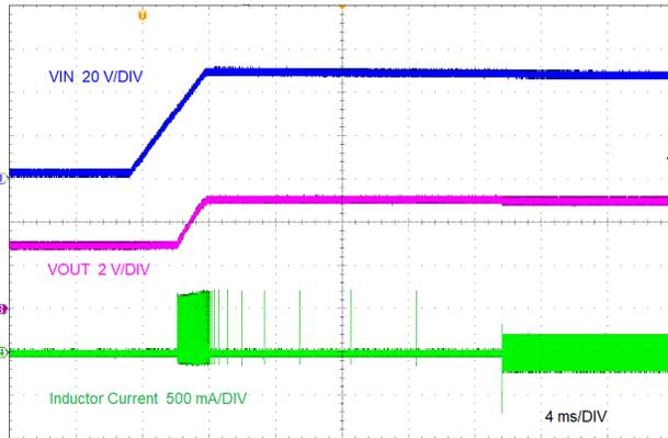
LMR38020-Q1  $V_{OUT} = 5\text{ V}$  No Load
