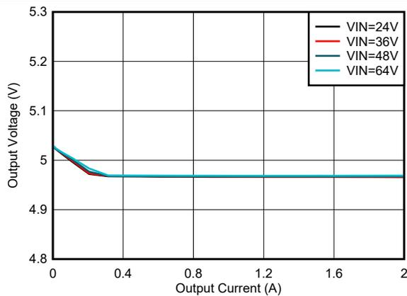
LMR38020-Q1  $V_{OUT} = 5\text{ V}$  400 kHz
