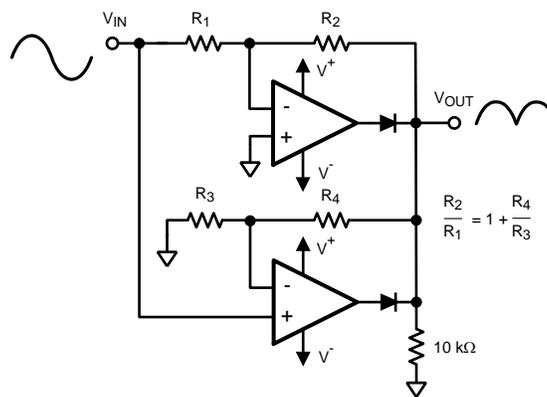
**Figure 57. Precision Rectifier**
