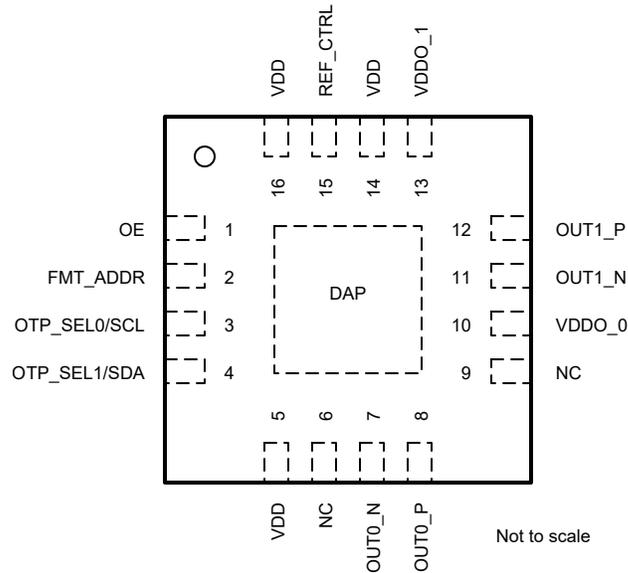
**Figure 4-1. LMK3H0102 16-Pin TQFN Top View**
