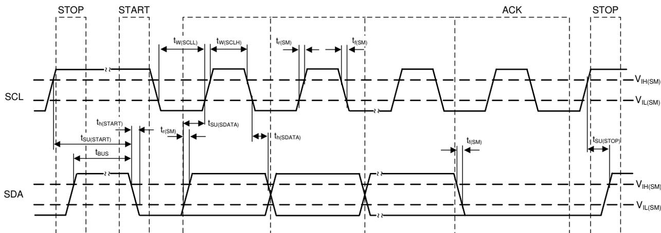
**Figure 7-9. I<sup>2</sup>C Timing Diagram**
