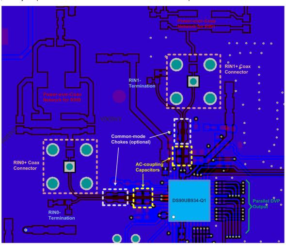
Figure 6-12. DS90UB934-Q1 Example PCB Layout
