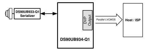
Figure 6-9. DS90UB933-Q1 Camera Data to 1 Rx Port
