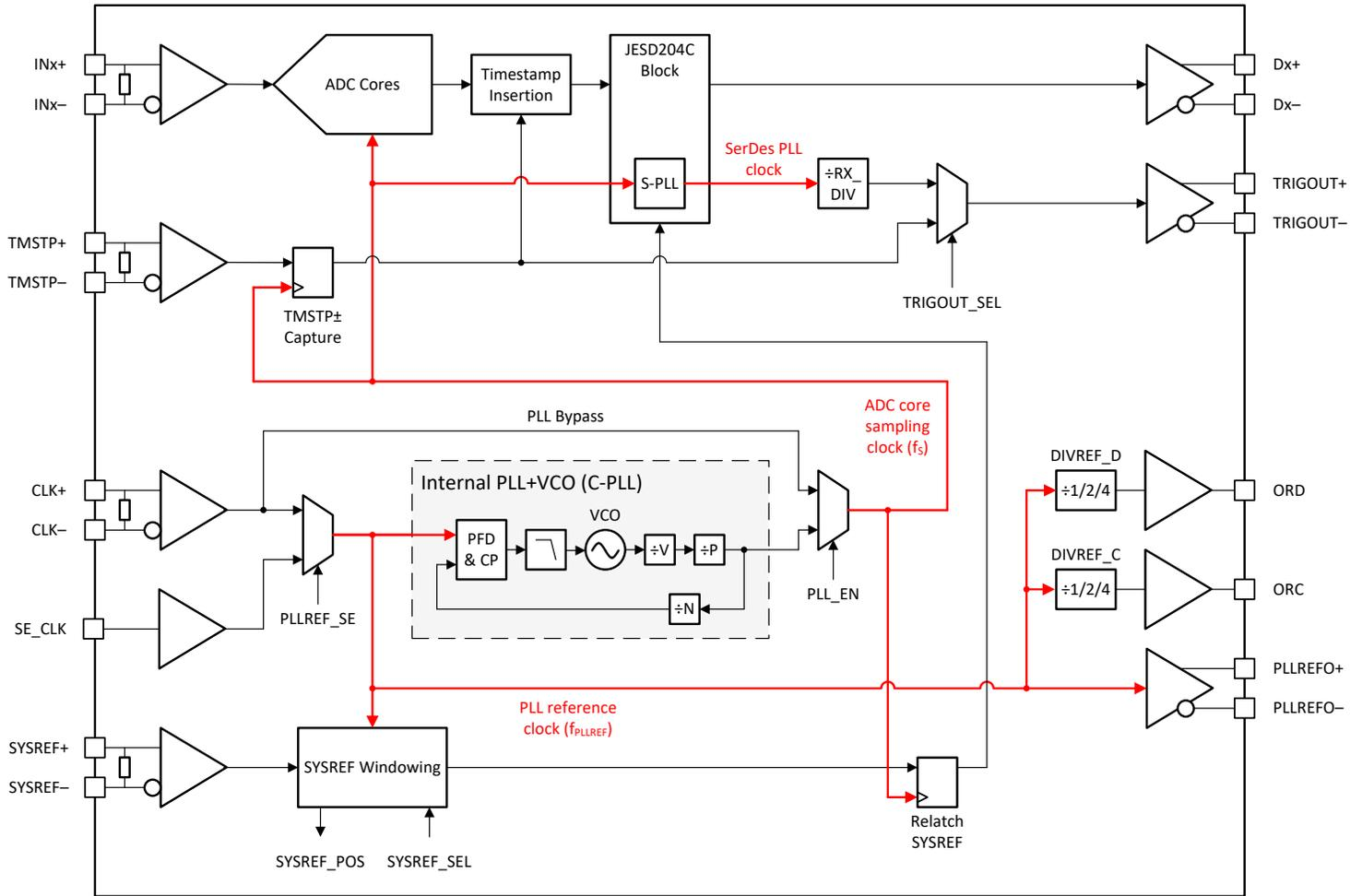
**Figure 6-3. Clocking Subsystem**
